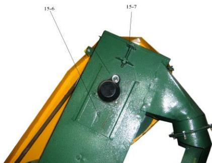
Рис.11 Регулирование натяжения цепи загрузочного транспортера
